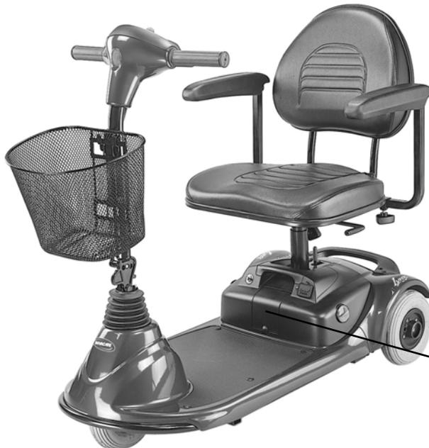
REMARQUE : L'étiquette des câbles de la batterie se trouve sur la paroi inférieure du couvercle du compartiment de batterie.
