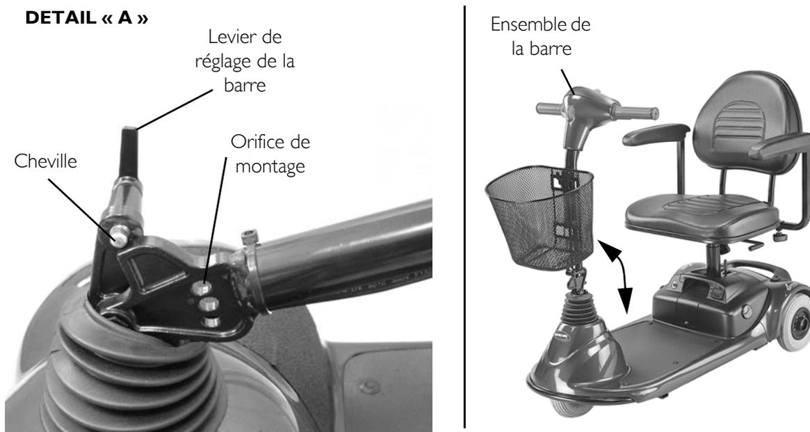
**FIGURE 8.1** Réglage de l'angle de la barre
