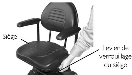
**FIGURE 7.1** Retrait/Installation du siège
