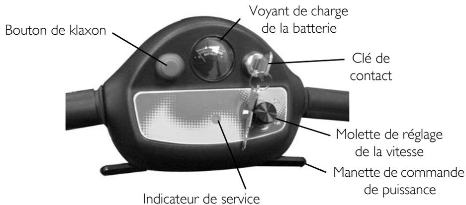
**FIGURE 6.1** Panneau de contrôle
