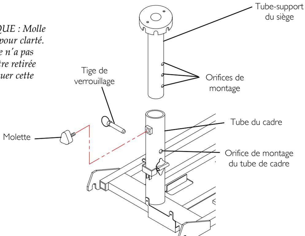
**FIGURE 7.2** Réglage de la hauteur du siège
