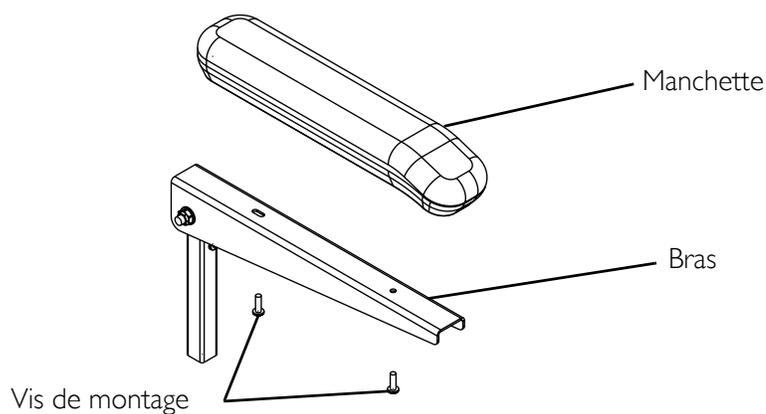
**FIGURE 7.5** Remplacement des coussins d'appuie-bras
