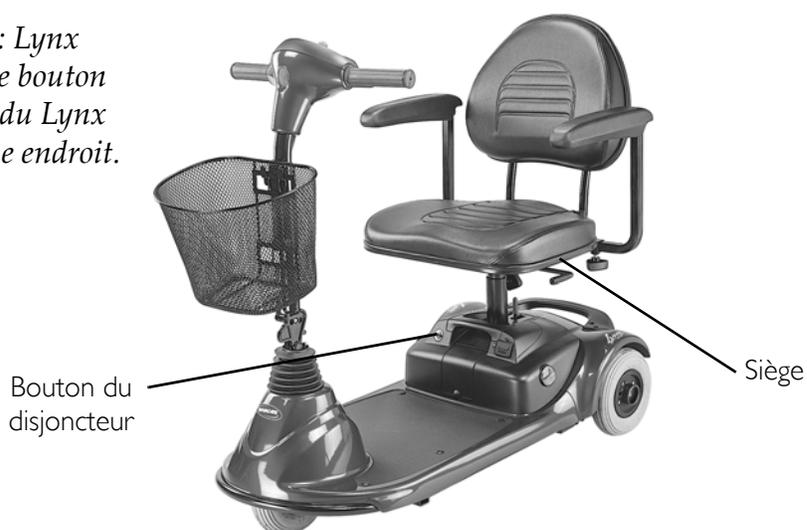
**FIGURE 5.1** Réinitialisation du disjoncteur
