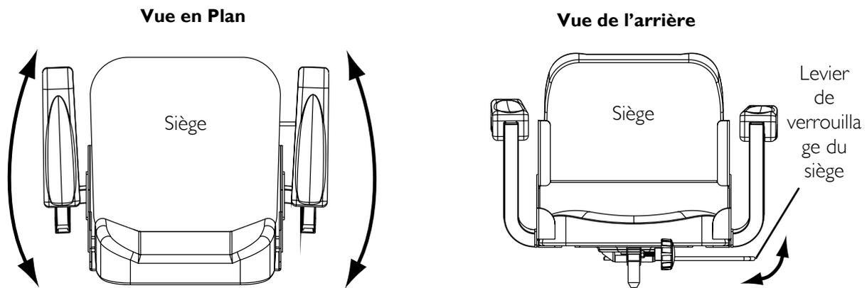
**FIGURE 7.3** Réglage du pivotement du siège sur 90°
