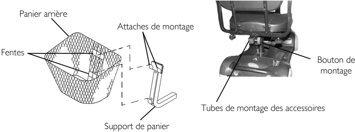
**FIGURE 12.6** Installation et retrait du panier arrière
