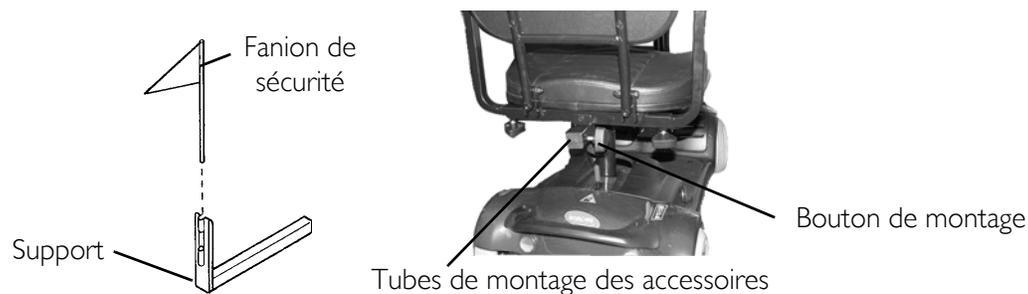
**FIGURE 12.3** Installation et retrait du fanion de sécurité
