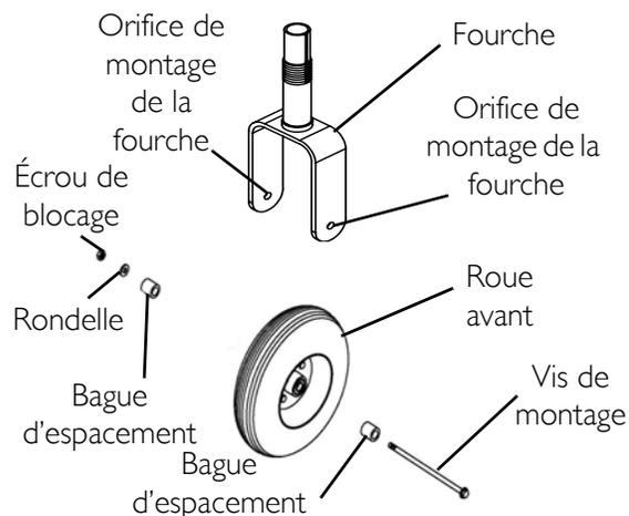
**FIGURE 9.2** Retrait et installation de la roue avant
