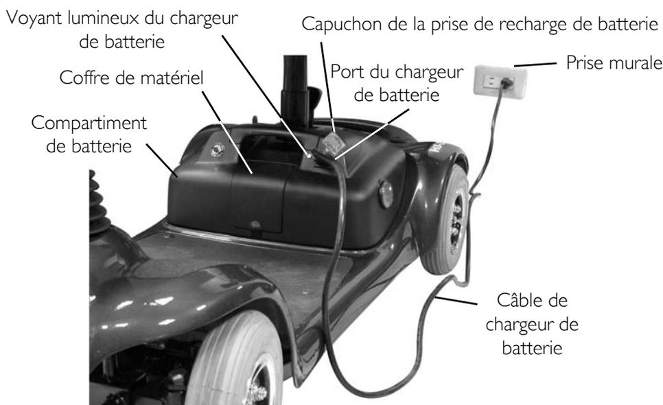
**FIGURE I0.4** Charge des batteries
