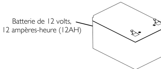
**FIGURE 10.1** Type de batterie recommandé
