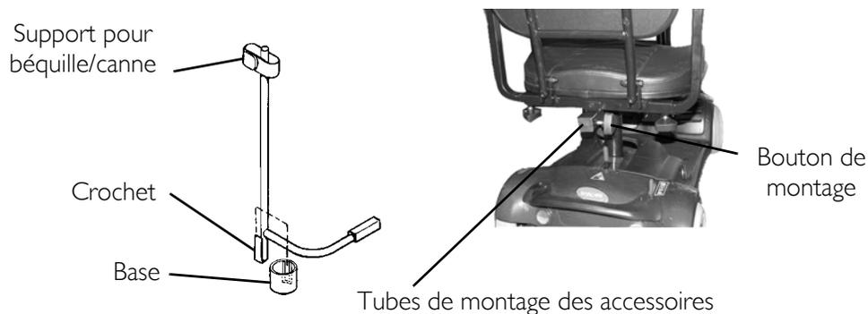
**FIGURE 12.2** Installation/retrait du support pour béquille/canne
