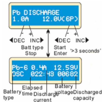
Définir le courant de décharge à gauche et la tension nominale à droite. La plage de courant est de 0.1-5.0A, la tension devrait correspondre à la la batterie une fois chargée. Appuyez sur START/ENTER pendant plus de 3 secondes pour commencer à (dé)charger.
