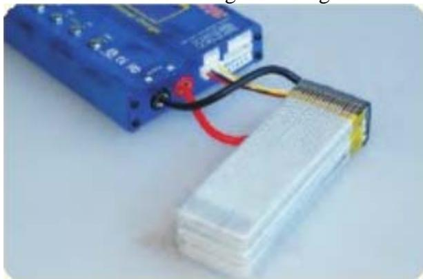
Avant de charger la batterie, les câbles principaux doivent être connectés, de même que le connecteur d'équilibrage, comme indiqué sur la photo ci-dessus.
