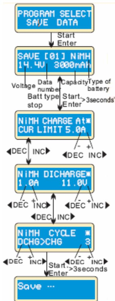
La configuration des paramètres sur l'écran n'affectera pas le processus de charge et décharge. Il présente juste les caractéristiques de la batterie. L'exemple est une NiMH, de 12 éléments et d'une capacité de 3000mAh.
