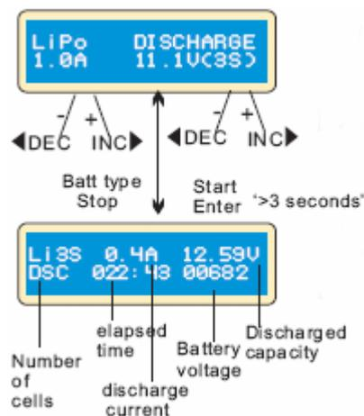
La valeur du courant de décharge à gauche ne doit pas excéder 1C, et la valeur à droite ne doit pas être inférieure à la la tension recommandée par le constructeur pour éviter de la décharger trop profondément. Appuyer START/ENTER pendant plus de 3 secondes pour commencer à charger.
