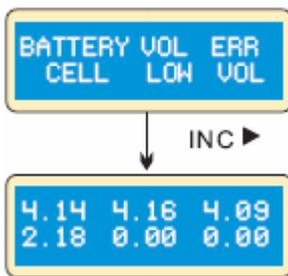
Le processeur détecte que la tension d'un élément est trop basse.
