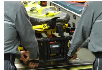
3- Une fois stabilisée, les opérateurs doivent tirer la civière hors du compartiment patient jusqu'à ce que la barre de sécurité engage le crochet de sécurité. Afin d'abaisser le charriot jusqu'à sa position complètement déployée, l'un des opérateurs appuie sur le bouton de déploiement (+).
