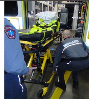
4- Une fois stabilisée, l'opérateur situé au pied de la civière doit pousser la civière dans le compartiment patient jusqu'à ce qu'elle engage le dispositif de fixation.
