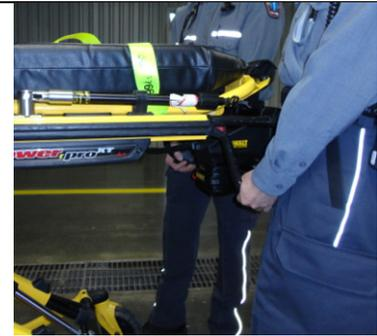
3- Afin de soulever le charriot jusqu'à sa position la plus haute, l'un des opérateurs appuie sur le bouton de déploiement (-).
