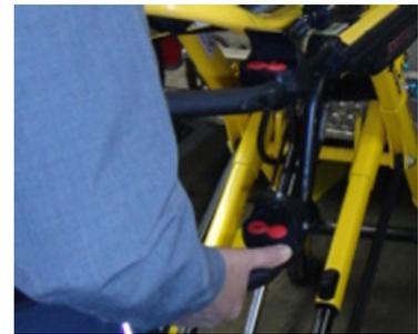
4- Une fois stabilisée, les opérateurs doivent pousser la civière dans le compartiment patient jusqu'à ce qu'elle engage le dispositif de fixation.
