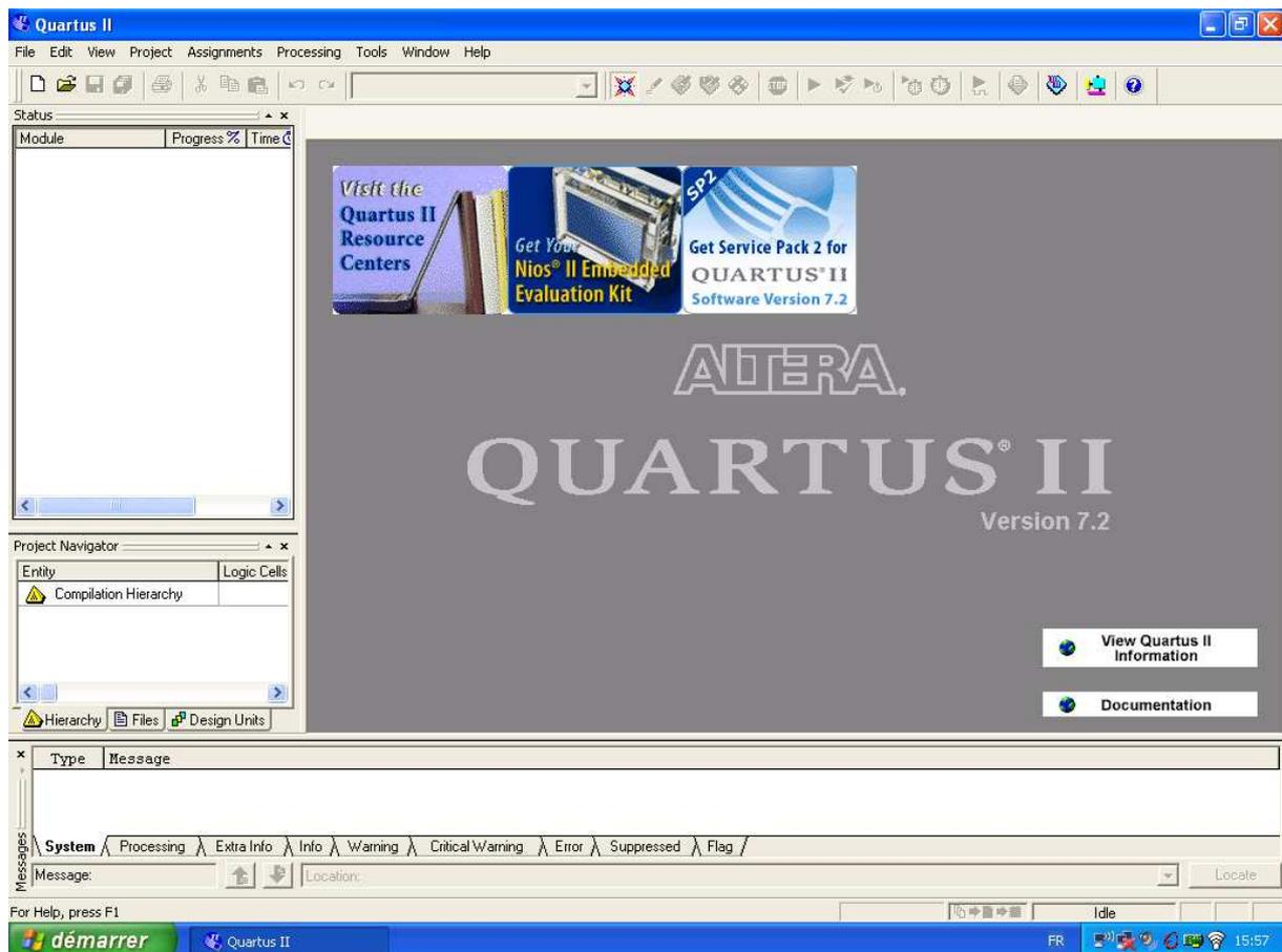
Quartus est un logiciel proposé par la société Altéra, permettant la gestion complète d'un flot de conception CPLD ou FPGA. Ce logiciel permet de faire une saisie graphique ou une saisie texte (description VHDL) d'en réaliser une simulation, une synthèse et une implémentation sur cible reprogrammable.
