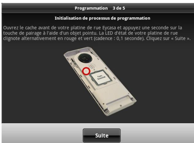
Si votre platine de rue fonctionne sur piles, appuyez une fois sur le bouton de la sonnette pour que l'appareil ne soit plus en mode de veille. Appuyez maintenant sur la touche de pairage de votre platine de rue. La LED d'état de votre platine de rue clignote alternativement en rouge et en vert et vous indique ainsi que la procédure de programmation a commencé. La procédure de programmation est active pendant environ 120 secondes. Cliquez sur « Suite ».
