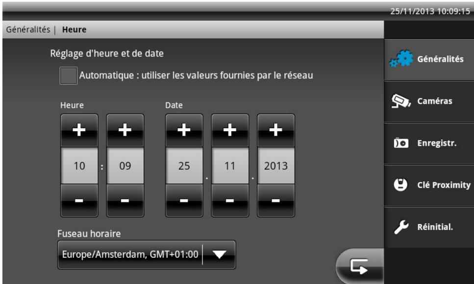
Activez le paramètre « Automatique » si votre module de base Eycasa est relié à votre réseau local (vous permettant d'accéder à internet). L'heure actuelle est alors déterminée automatiquement par NTP (Network Time Protocol) et régulièrement ajustée. L'ajustement se fait une fois par jour ou suite à un redémarrage du module de base Eycasa.
