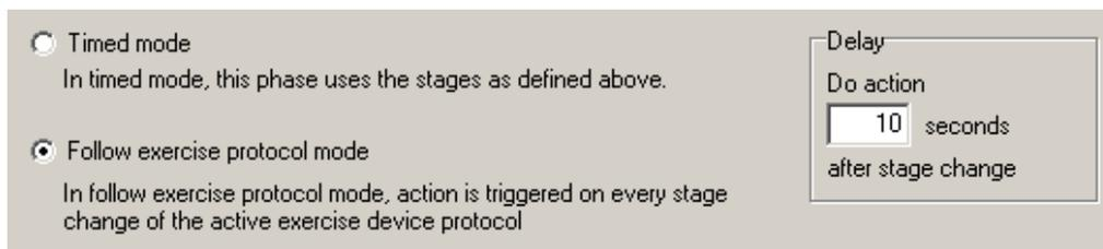
1. Sélectionner **Mode horaires** pour créer un protocole qui s'exécute indépendamment des paliers de l'ergonmètre ou du tapis roulant. Un protocole indépendant est constitué de paliers, qui ont chacun leur propre durée. Que l'utilisateur maintienne ou accélère un palier de système d'épreuve d'effort, le protocole indépendant de pression artérielle ou d'imprimante se poursuit avec les intervalles de paliers définis pour ce protocole.
