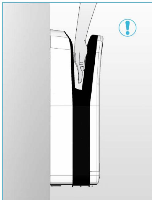
Wenn Sie die Hände vom Trockner entfernen, unterbricht dieser den Trocknungsvorgang und wartet auf den nächsten Benutzer. Wenn die Hände länger als 25 Sekunden im Trockner verbleiben, schaltet sich dieser automatisch ab.
