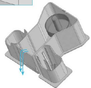
Wenn das Wasser das maximale Niveau im Speicher erreicht hat, erzeugt das Gerät einen optischen Alarm an der Geräteoberseite (rotes Licht) sowie ein akustisches Warnsignal. Der Wasserspeicher des Geräts muss entnommen, entleert und danach wieder eingesetzt werden. **Der Wasserspeicher muss mindesten einmal pro Woche überprüft und geleert werden.**
