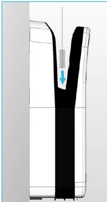
Dieses Produkt wird mit einer Bürste geliefert, welche für die Reinigung des Entwässerungskanals zu benutzen ist.
