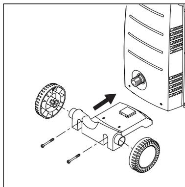
1. Montez le support en le faisant glisser dans le guide jusqu'au fond et le fixer à l'aide des 2 vis.
