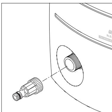
1. Vissez fermement le raccord rapide sur l'arrivée d'eau (2).
