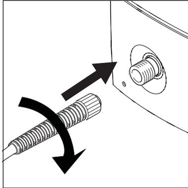
1. Montez le tuyau haute pression (4) sur la sortie d'eau (3).
