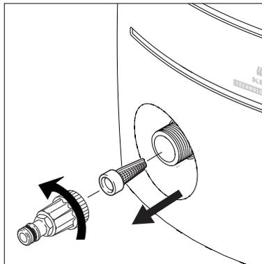
fréquence d'utilisation. Dévissez délicatement le filtre à l'aide d'un tournevis, puis nettoyez-le. Vérifiez qu'il est intact avant de le réinstaller.
