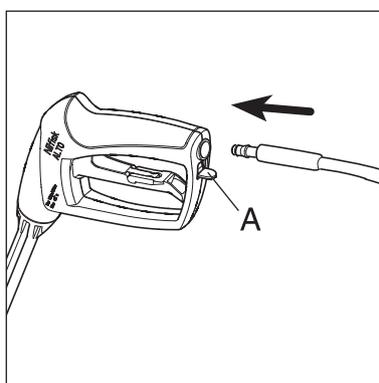
1. Montez le tuyau haute pression (4) sur le pistolet pulvérisateur (7).
