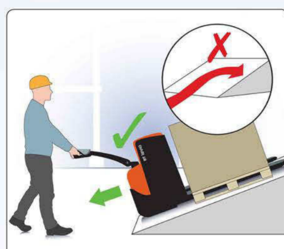
En pente, conduisez lentement en ligne droite et en gardant la charge face à la pente. Ne jamais faire de demi-tour sur rampe.
