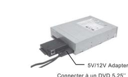
Pour un dispositif de CD/DVD 5.25", branchez directement le Connecteur de SATA ou le connecter à 40 goupilles dans les ports appropriés sur l'arrière du dispositif de CD/DVD, et branchez la prise de signal / données d'USB (noir) au port d'USB du PC, puis branchez l'extrémité de l'alimentation de courant à une douille de courant à 6 goupilles, et l'autre extrémité à la source de courant.
