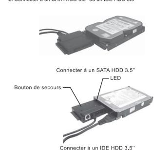
Pour un SATA HDD 3.5" ou un HDD d'IDE 3.5", branchez directement le Connecteur de SATA ou le connecter à 40 goupilles dans les ports appropriés sur l'arrière du HDD, et branchez la prise de signal / données d'USB (noir) au port d'USB du PC, puis branchez l'extrémité de l'alimentation de courant à la douille de courant à 6 goupilles, et l'autre extrémité à la source de courant.
