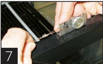
Support de porte à galets muni d'un cordon métallique.
