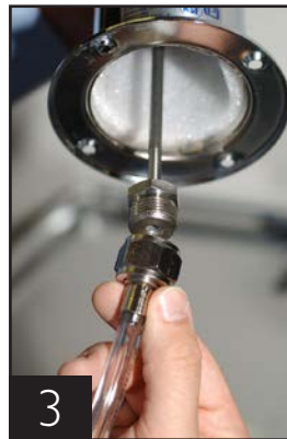
3 Enfilez la ligne python dans la colonne de tirage et fixez la colonne au bac en plaçant le joint en caoutchouc sous la colonne de tirage.
