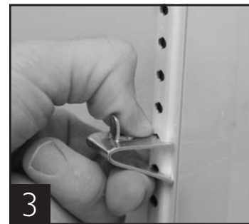
Il faudra peut-être comprimer ou tordre la partie inférieure du clip pour la faire rentrer
