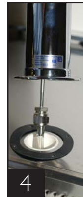
3 Enfilez la ligne python dans la colonne de tirage et fixez la colonne au bac en plaçant le joint en caoutchouc sous la colonne de tirage.
