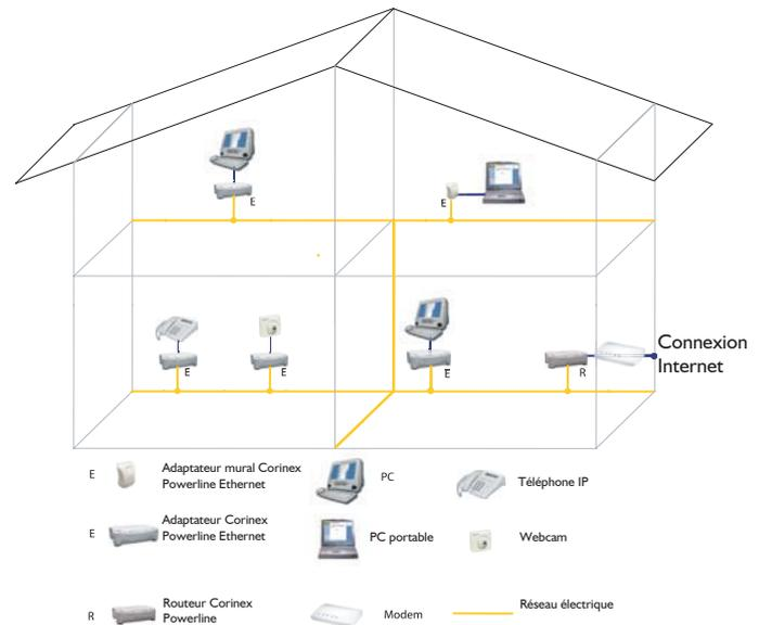
L'adaptateur Corinex Powerline Ethernet est compatible avec toute la gamme de produits Corinex Powerline ou CableLAN comprenant :
