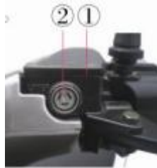
Figure 29-2 fenetre de niveau du frein avant
