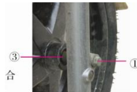
Figure 31-2 Schéma du démontage de roué avant
