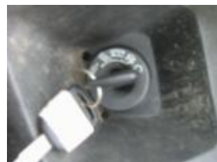
Figure 17 Interrupteur du démarrage
