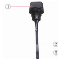
Figure 20-2 (1) jauge a huile (2) Calibration supérieure (3) Calibration inférieure
