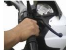
Figure 26 Rotation de la poignée d'accélérateur.
