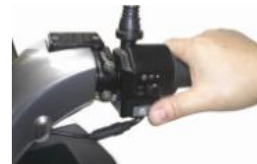
Figure 18 Accélérer légèrement, en appuyant sur l'interrupteur du démarrage.
