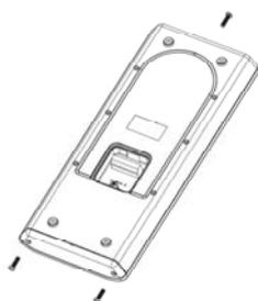
Si votre platine de rue fonctionne avec une alimentation électrique permanente (transformateur pour sonnette), enlevez le cache de la borne de raccordement à l'arrière de l'appareil.
