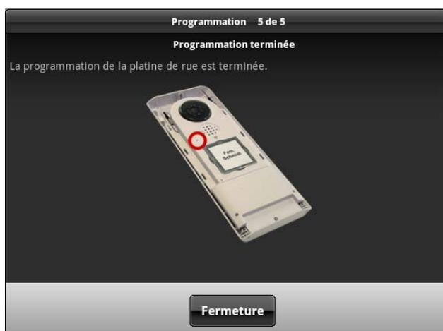
Si le message « La programmation de la platine de rue est terminée » apparaît, la procédure de programmation est finie. La LED d'état de votre platine de rue s'éteint vous indiquant que l'appareil est prêt à fonctionner.
