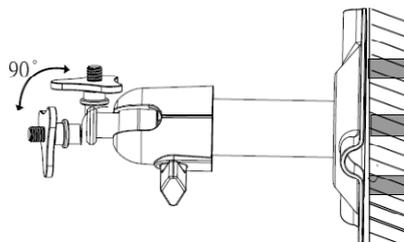
Vissez ensuite la caméra sur le support et raccordez le bloc d'alimentation à la caméra.
