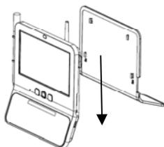
2. Placez le support mural sur le mur à la position souhaitée et marquez les trous à percer. La distance entre les deux trous est de 102 mm.
