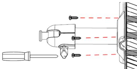
Vous avez la possibilité de faire pivoter le support de 90° pour sélectionner la position voulue. Dévissez d'abord la vis sur le côté et réglez l'angle de visée voulu. Serrez enfin la vis afin de fixer le support dans la position voulue.
