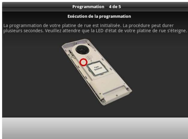
Votre module de base Eycasa se connecte avec votre platine de rue. La procédure peut durer plusieurs secondes. L'assistant de configuration vous indique si la procédure est terminée ou si, en cas d'erreur de pairage, elle doit être recommencée.
