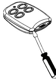
Figure B.12: Ouverture du boîtier EL-2614
