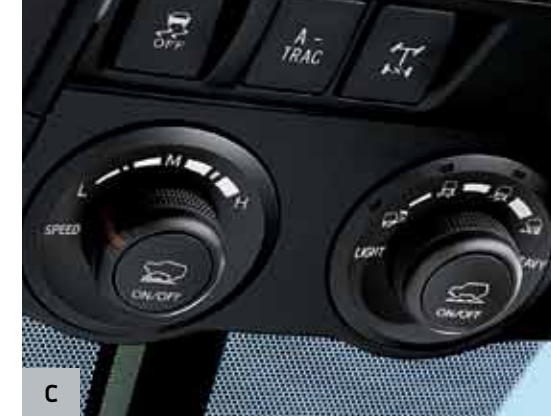
C. Pour certaines conditions de conduite hors route, le conducteur dispose de deux fonctions réglables. Pour améliorer la conduite et la traction, le système de sélection multi-terrain vous permet d'adapter la conduite à quatre types de terrains : boue et sable, terrain caillouteux, bosses ou roches. Pour franchir des obstacles à vitesse très lente, le régulateur de vitesse lente module le papillon à commande électronique et les freins pour que vous puissiez mieux vous concentrer sur la direction. (Édition Trail seulement)
