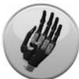
**Rangement rapide du pouce** – les quatre doigts restent ouverts et se désactivent, pendant 1,5 seconde le pouce se ferme et revient automatiquement vers une position ouverte.
