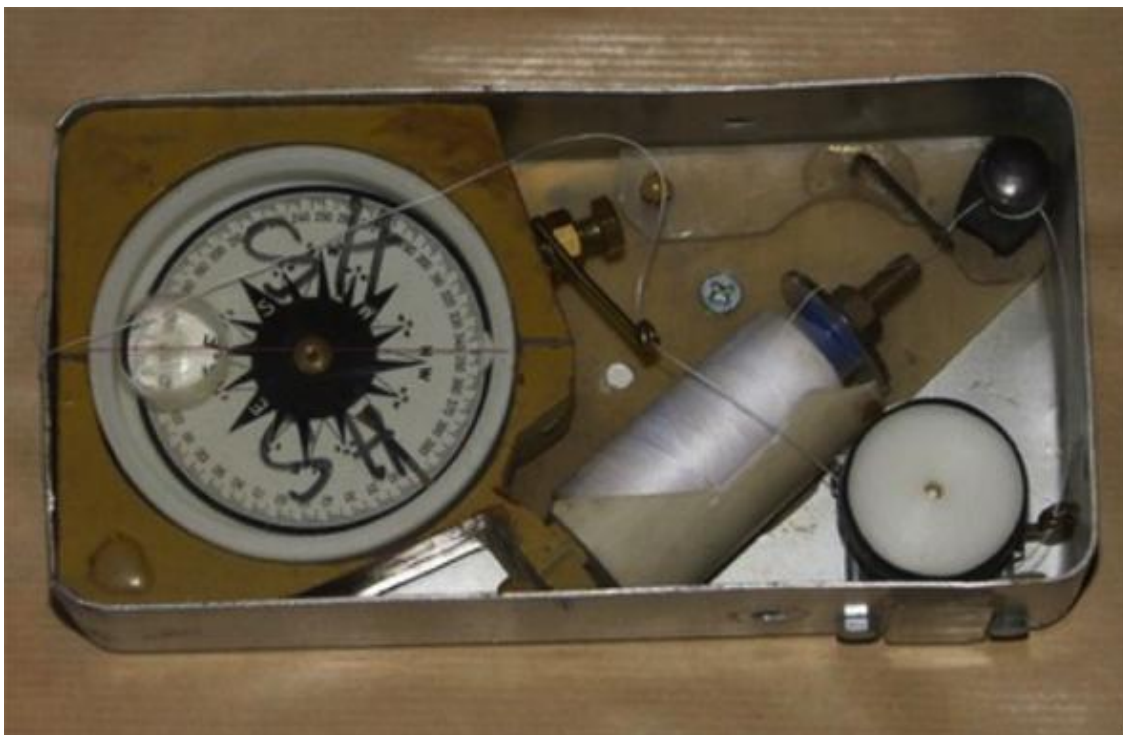
Figure 1- Topofil Vulcain (1970) : distance, azimut et inclinaison dans un appareil compact. L'ancêtre mécanique (et analogique) du DistoX ?
