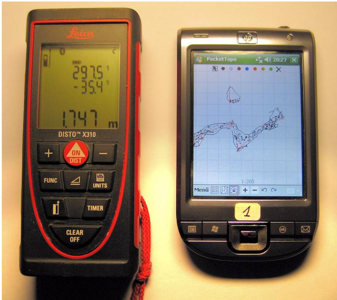
Figure 4- Dernière génération : DistoX2 et PDA. La révolution V 2.0
