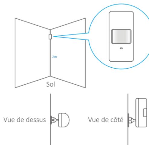
Fixer le support sur le mur à l'aide de vis et attacher le détecteur au support. Ajuster la hauteur de l'installation ou du support pour changer la distance de détection et l'angle. Il est recommandé de le monter à une distance de 2 mètres du sol.
