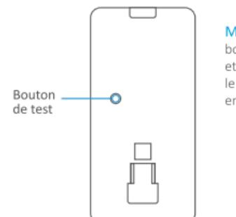
**Mode test :** Après l'autotest, appuyer sur le bouton de test, le détecteur passe en mode de test, et détecte toutes les 10 secondes. Après 3 minutes, le voyant clignote deux fois, puis le détecteur passe en mode de fonctionnement.
