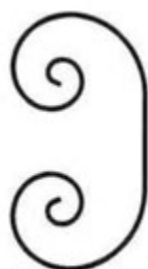
Exemple d'un rouleau de type « C »
