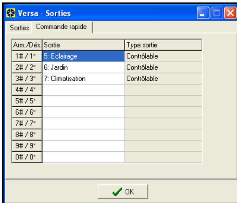
Fig. 11. Attribution des sorties aux touches appropriées du clavier dans le logiciel DLOADX (exemple de la configuration).
