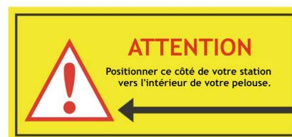
Vérifier le bon positionnement de la station de charge.
