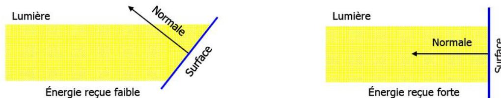
FIG. 3.6 – Modèle de la réflexion diffuse
