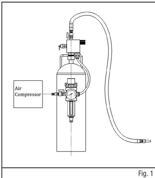
1. Utilisez une trémie afin de verser 10 lb de bicarbonate de soude dans le réservoir de stockage (n° 1) avant de procéder à l'assemblage.
