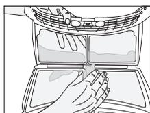
Une couche peut se former sur les pores du filtre et entraîner un bouchage du filtre après avoir utilisé le sèche-linge pendant un certain temps. Lavez le filtre à l'eau chaude pour enlever la couche qui se forme sur la surface du filtre. Séchez le filtre à peluche complètement avant de le réinstaller.
