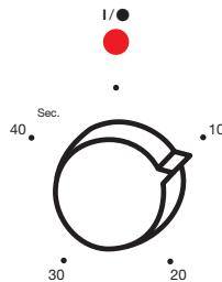
Utilizzarlo per regolare il macinacaffè in modo che macini per il tempo e la quantità desiderati. L'apparecchio si spegne automaticamente al termine del tempo impostato. Se si vuole interrompere la macinazione prima che sia trascorso il tempo impostato: premere il pulsante I/O (fig. 10).
