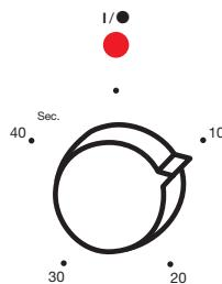
Elle permet de régler le broyeur sur un temps de broyage précis, de manière à délivrer une certaine quantité de café. L'appareil s'éteint automatiquement une fois que le temps est écoulé. Si vous souhaitez interrompre le broyage avant que le temps prédéfini soit écoulé, appuyez sur le bouton I/O (fig.10).
