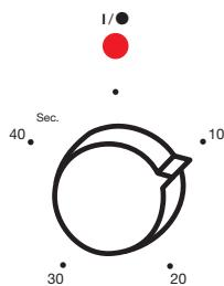
Den kan du använda för att ställa in kaffekvarnen på önskad tid eller mängd. Apparaten stänger av sig automatiskt när den förutbestämda tiden gått. Om du vill avbryta malningen innan den förinställda tiden gått. Tryck på I/O-knappen (fig.10).
