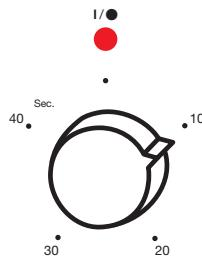
Use-o para ajustar o moinho de café ao tempo e à quantidade moída desejada. O equipamento desliga-se automaticamente assim que o tempo predefinido tenha decorrido. Se desejar interromper a moagem antes do fim do tempo predefinido carregue no interruptor principal (I/O) (fig.10).
