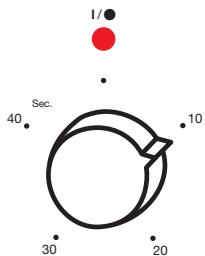
Damit lässt sich die gewünschte Mahlzeit bzw. Pulvermenge einstellen. Nach Ablauf der eingestellten Zeit schaltet sich das Gerät automatisch aus. Falls Sie den Mahlvorgang vor Ablauf der eingestellten Zeit abbrechen möchten, drücken Sie die Taste I/O (Abb. 10).
