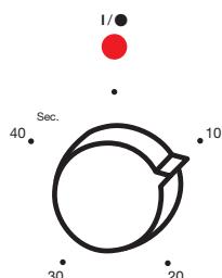
Met deze schakelaar kunt u de maalduur en de gemalen hoeveelheid instellen. Het apparaat schakelt automatisch uit als de vooraf ingestelde tijd verstreken is. Als u het malen vóór het einde van de ingestelde tijd wilt onderbreken, drukt u op de I/O knop (fig. 10).
