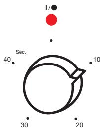
Denne knap anvendes til at indstille kaffemøllen på den ønskede maletid og doseringsmængde. Apparatet slukker automatisk, når den indstillede tid er gået. Ønsker du at afbryde, før den indstillede tid er gået, trykkes på I/O-knappen (fig. 10).
