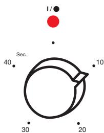
Use este control para seleccionar la dosis de café y el tiempo de molienda deseados. El aparato se desconecta automáticamente una vez transcurrido el tiempo seleccionado. Si desea interrumpir la molienda antes del tiempo seleccionado, pulse el botón I/O (fig.10).
