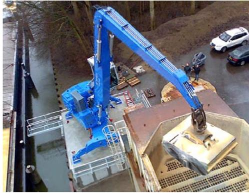
La AHL850 alimente la trémie du silo de fourrage avec un rythme de travail de 2,5 cycles par minute
