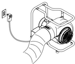
Conecte el ventilador a la fuente de alimentación de energía eléctrica (120 VCA, 15 A, 60 Hz). Tous les ventilateurs électriques standard comportent un disjoncteur de fuite à la terre, conformément à la norme NEC 1996, article 305-6.
