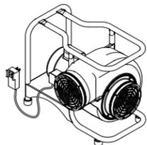
Placer le ventilateur dans un environnement d'air pur. Placez le ventilateur à distance d'au moins 1.5 mètres de l'orifice d'accès. **Remarque: Inspecter le ventilateur pour dommages ou éléments usés. Inspecter tous les conduits et les joints pour fuites d'air avant l'opération du ventilateur.**
