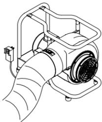
Installer le bracelet du conduit à la collerette d'échappement et serrer la sangle collier. Vous assurer de garder les changements de directions et les torsions du conduit au minimum pour maximiser la circulation de l'air. Si le modèle cartouche est utilisé, ouvrir le couvercle et retirer le conduit, puis inspecter pour fuites d'air.
