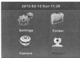
(1) Utiliser les touches gauche/droite pour vous placer sur le menu «moniteur», valider avec « ENTER ».
