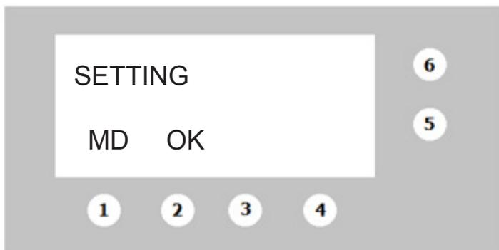
L'accès au menu de paramétrage se fait par l'appui sur la touche **1 (MD)** du menu d'accueil. Lorsque l'affichage indique **SETTING**, appuyer sur la touche **2 (OK)** pour entrer en mode installation / paramétrage.
