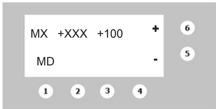
Le principe est le même que précédemment. Il faut tout d'abord régler l'armoire de commande à 100% d'éclairage. Il faut amener la valeur **XXX** à 100% en l'ajustant à l'aide des boutons 5 (-) et 6 (+).
