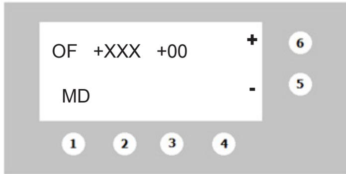
Il faut régler l'armoire de commande à 0% d'éclairage. **XXX** indique la valeur mesurée à l'entrée, elle devrait être aux alentours de 0. Il faut à l'aide des boutons 5 (-) et 6 (+) amener la valeur XXX à 000. Une fois ce réglage effectué, valider en appuyant sur le bouton 1 (MD).
