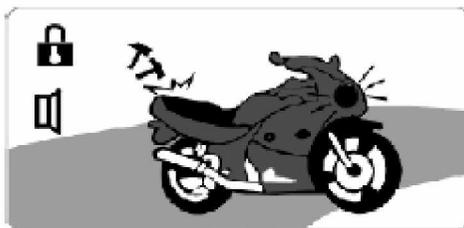
**Détection du contact :** Lorsque l'alarme est armée, si le contact est mis, l'alarme sonnera 30 secondes, la télécommande jouera une mélodie et affichera :
