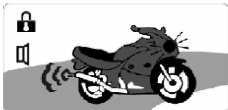
**Armement automatique :** Lorsque vous coupez le contact, l'alarme s'armera automatiquement sans les bips au bout de 60 secondes (option programmable).
