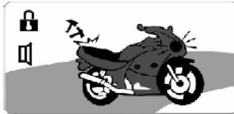
**Réglage de la sensibilité des chocs :** Il y a 4 niveaux de sensibilité. Le plus haut niveau correspond à la sensibilité maximale. Le plus bas niveau désactive le détecteur de choc, c'est utile si l'environnement est perturbé, travaux, garé proche de la route, etc. Cela évite de voir son alarme sonner toutes les 5 minutes.
