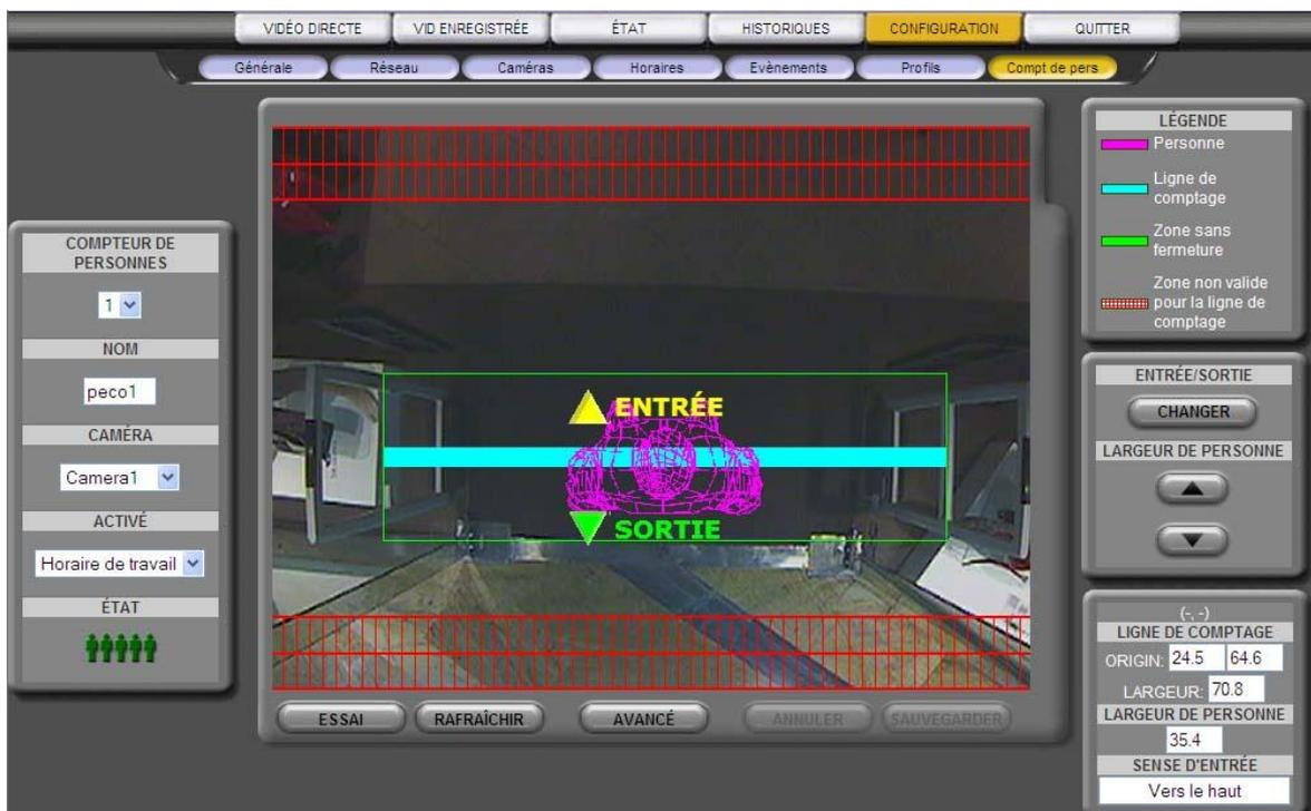
Fig. 6 – Configuration du compteur
