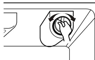
S'il ne peut pas tourner le filtre du côté au côté, signifie qu'un n'est pas placé correctement. Appuyez fermement et tournez jusqu'à ce qu'il écoute le clic. Tournez la cartouche vers la droite de retour 1/4. Vous écoutez le clic, qui signifie que le filtre est sur la garde.
