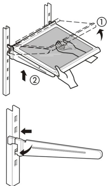
**REMARQUE:** S'assurer que la clayette est placée de façon bien horizontale et qu'elle ne bascule ni d'un côté ni de l'autre. Sinon, la clayette peut tomber, causant des déversements ou du gaspillage d'aliments.
