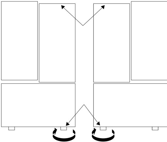
3. Ouvrez encore une fois les deux portes et examinez-les pour vérifier qu'elles se ferment facilement. Autrement, inclinez légèrement le réfrigérateur plus vers l'arrière en faisant tourner les deux vis de réglage dans le sens des aiguilles d'une montre. Il peut être nécessaire de faire tourner la vis de réglage plusieurs fois et vous devez faire tourner les deux vis de réglage le même nombre de fois.
