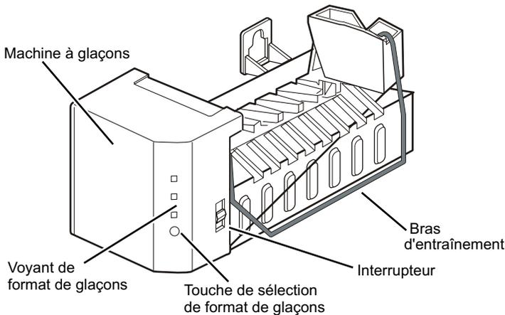
La machine à glaçon produit 8 glaçons par cycle environ 100 à 130 pour une période de 24 heures, selon la température du congélateur, de la pièce, du nombre d'ouverture de porte et autres conditions.
