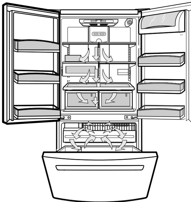
Ne bloquez pas une de ces sorties avec paquets d'aliments. Si les sorties sont bloquées, le flux d'air sera interrompu et la température et humidité causeront problèmes.
