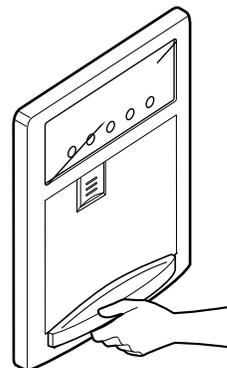
Inclinez vers le haut de l'avant du plateau légèrement et cassez les nervures dans les trous pour remplacer le plateau.
