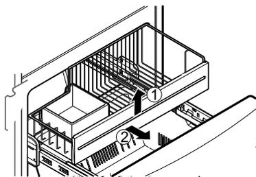
2. Pour installer, tirer les deux rails complètement. Accrocher les supports de panier sur les languettes de rail et pousser dans le compartiment.
