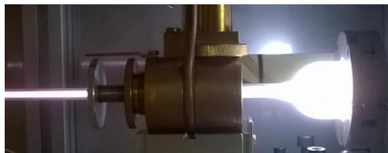
Figure 26 – Lumière visible émise par un plasma d'argon allumé
