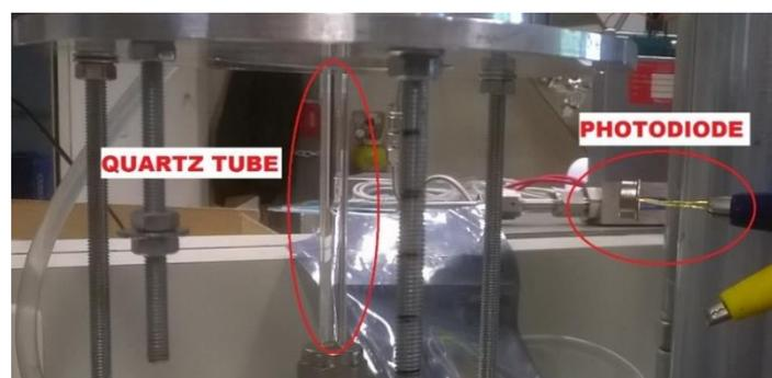
Figure 29 – Positionnement de la photodiode lors de l'expérience
