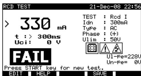
Exemple de résultats de mesure de courant de déclenchement d'un DDR
