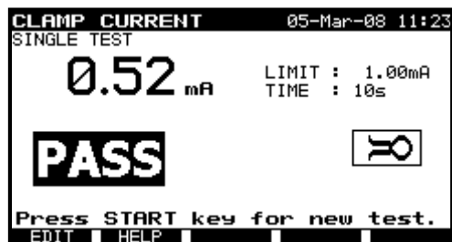
Exemples de résultats de mesure avec une pince ampérométrique
