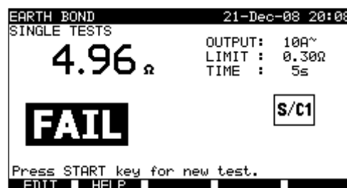
Exemples de résultats de mesure de résistance de conducteur de protection
