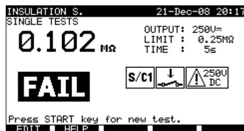
Exemples de résultats de mesure de résistance d'isolement S
