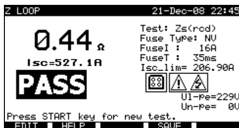
Exemples de résultats de mesure d'impédance en boucle
