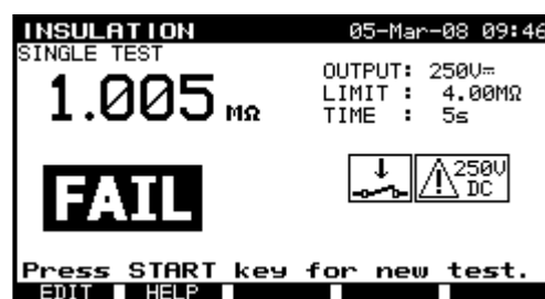
Exemples de résultats de mesure de résistance d'isolement
