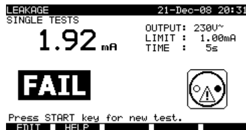
Exemples de résultats de mesure de courant différentiel
