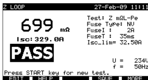
Exemple de résultats des mesures Z \text{ m}\Omega\text{-PE}
