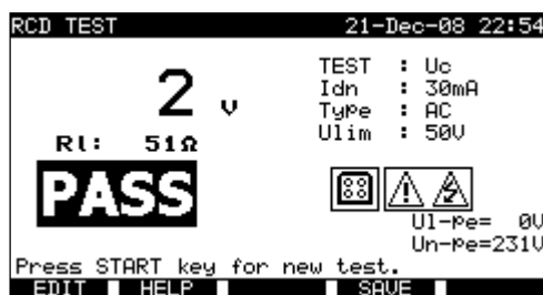
Exemple de résultats de mesure de tension de contact
