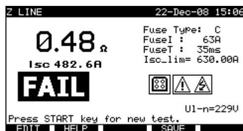
Exemples de résultats de mesure d'impédance de ligne
