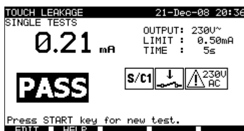
Exemples de résultats de mesure de courant de fuite de contact
