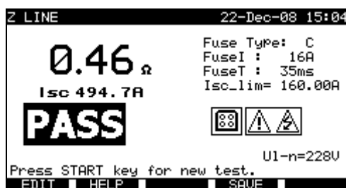
Exemples de résultats de mesure d'impédance de ligne
