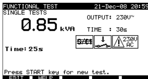
Exemple de résultat de mesure de puissance apparente
