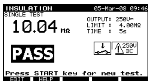
Exemples de résultats de mesure de résistance d'isolement
