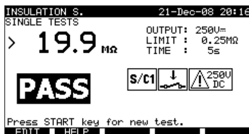
Exemples de résultats de mesure de résistance d'isolement S
