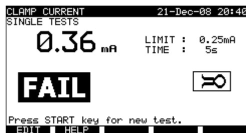
Exemples de résultats de mesure avec une pince ampérométrique
