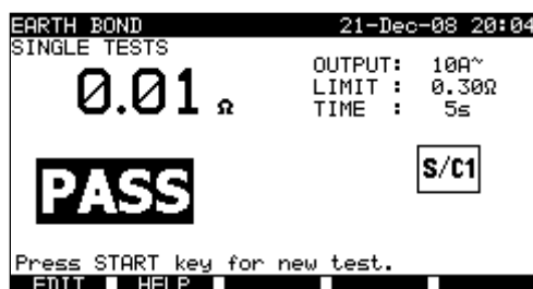
Exemples de résultats de mesure de résistance de conducteur de protection
