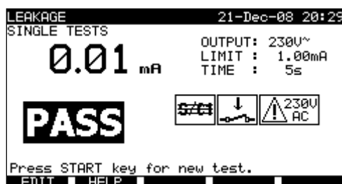
Exemples de résultats de mesure de courant différentiel
