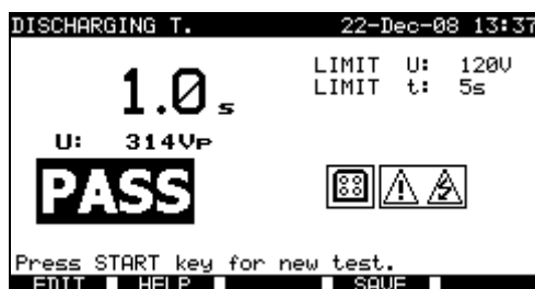
Exemples de résultats de mesure de temps de décharge
