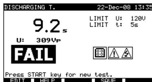
Exemples de résultats de mesure de temps de décharge
