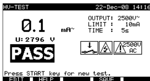
Exemples de résultats de mesure en haute tension
