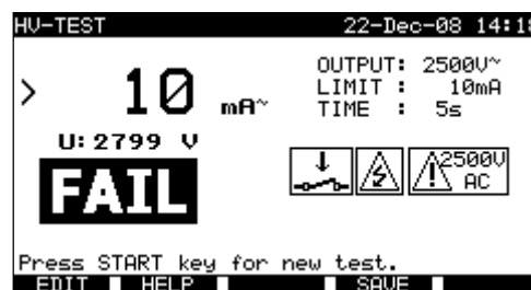
Exemples de résultats de mesure en haute tension
