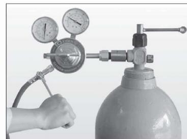
Figure 13. Branchement du tuyau
