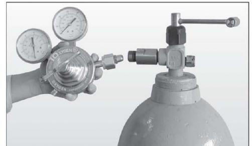
Figure 8. Inspection de la bouteille et du robinet de bouteille
