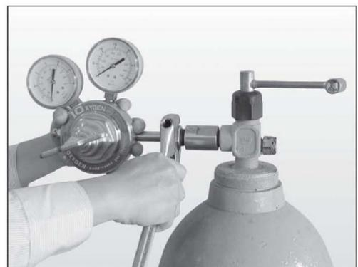
Figure 10. Serrage du détendeur
