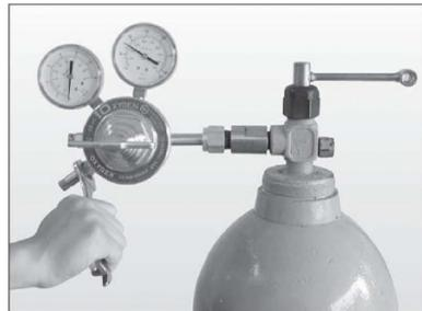
Figure 12. Raccordement de clapets antiretour
