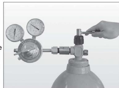
Figure 11. Ouverture du robinet de la bouteille
