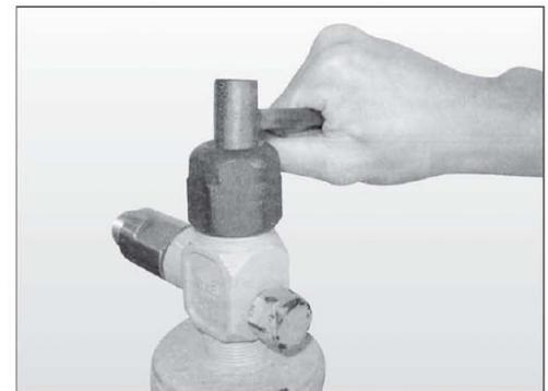
Figure 9. Ouverture partielle du robinet de bouteille
