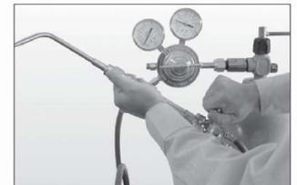
Figure 15. Raccordement de la buse de soudage au manche du chalumeau
