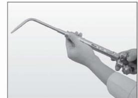
Figure 14. Branchement du tuyau au manche du chalumeau
