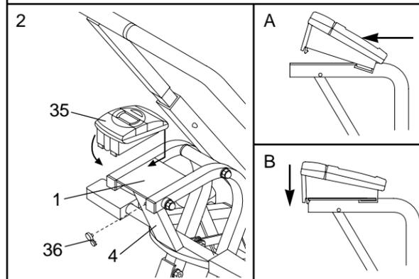
3. Enlevez le couvercle des piles du Moniteur (35). Insérez deux nouvelles piles 1,5V dans le Moniteur. Identifiez les pôles négatifs (-) et les pôles positifs (+). Les pôles négatifs des piles doivent toucher les ressorts dans le compartiment des piles.
