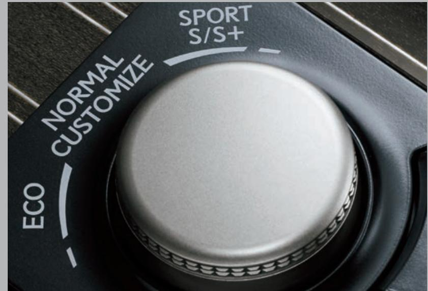
**SÉLECTEUR DE MODE DE CONDUITE** L'accélération et la direction se déploient maintenant en un éventail de possibilités grâce au sélecteur de mode de conduite qui permet au conducteur de choisir son mode de conduite préféré parmi les modes ECO, Normal, Sport S et Sport S+. Du nouveau : le dernier mode de conduite sélectionné reste en mémoire jusqu'au démarrage suivant afin de vous offrir une conduite sur mesure.
