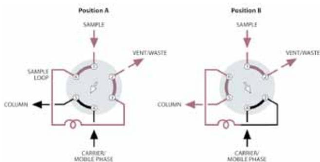
Vanne 6 voies - 2 positions avec boucle = vanne d'injection
