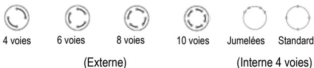
Type : fonction de l'emplacement des orifices
