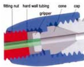
Option "Raccords 1/4"-28 : utilisation d'un raccords 1/4"-28 + joint (voir paragraphe Omniloc) et d'une ferrule conique (ferrules pour Omnifit-Caps).
