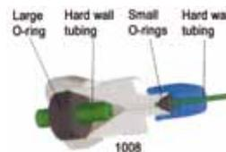
Comparaison connexions raccords grands diamètres et raccords diamètres standards.
