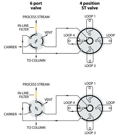
Vanne 2 positions 6 voies + vanne STF 4 positions : filtration de l'échantillon, échantillonnage puis injection dans une colonne.
