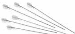
Aiguilles faible diamètre (gauge 27 - 33)
