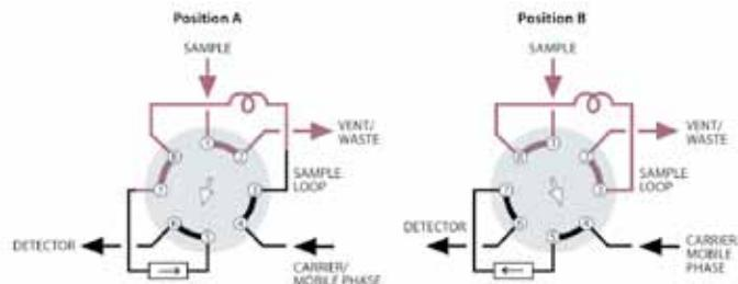
Vanne 8 voies - 2 positions avec boucle = vanne d'injection et système backflush
