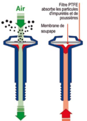
**Lors du fonctionnement de l'installation HPLC, la membrane est ouverte**
