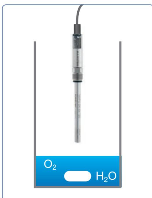
Illustration 15 : Configuration de l'étalonnage dans un milieu saturé
