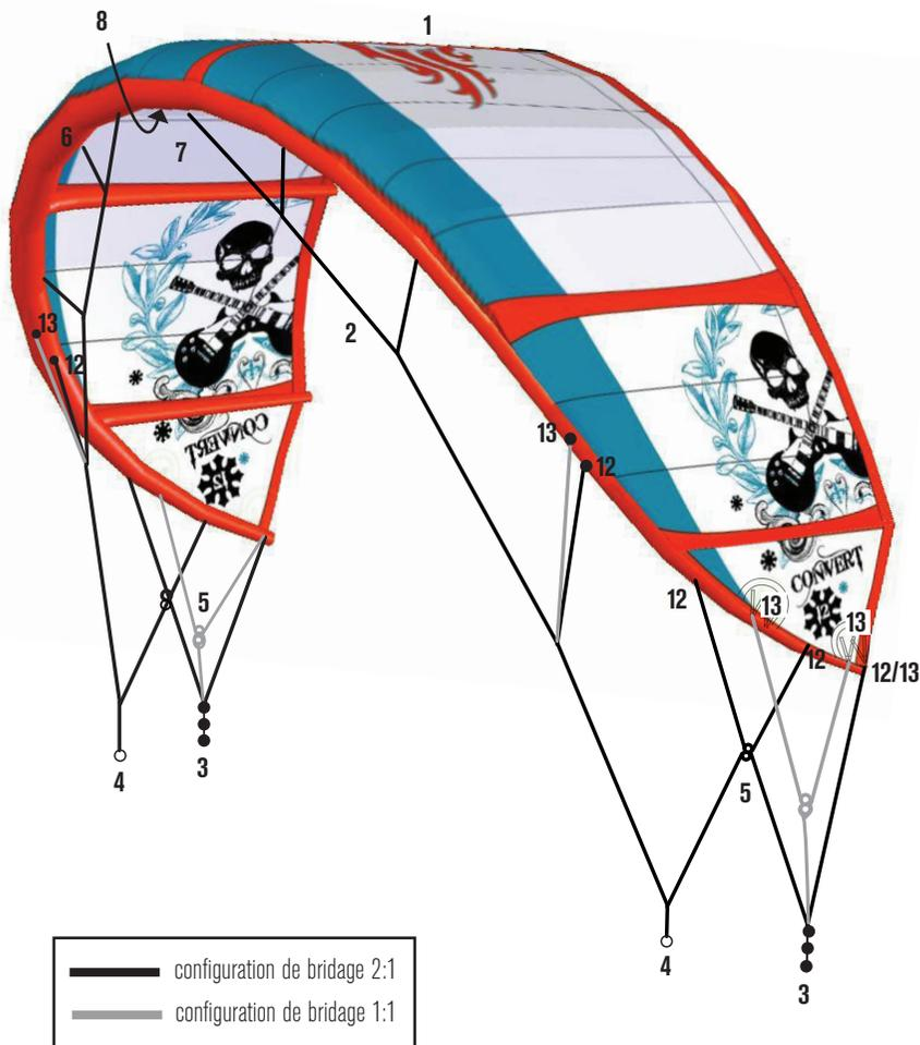
L'aile Convert peut être modifiée d'une configuration de bridage 2:1 en configuration 1:1. Le réglage 2 :1 est fait pour être utilisé avec le système de contrôle 2:1 avec poulies. Le réglage 1:1 est fait pour être utilisé avec le système de contrôle 1:1 sans poulie.
