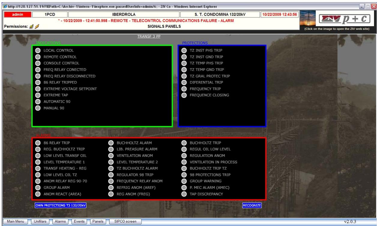
figure 4.16: panneau de signaux numériques d'une position
