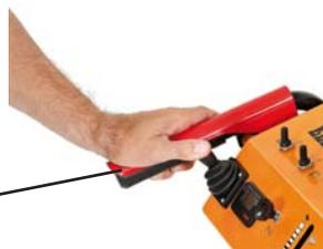
Le pommeau est automatiquement prépositionné sur le régime vitesse lente. Si le régime rapide est choisi pour le déplacement, il convient de placer le pommeau vers la gauche avant d'enfoncer le levier de point mort.
