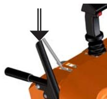
En activant le levier de point mort, le levier noir demeure dans la même position. L'opérateur a alors la possibilité de commander la machine de la main droite, à l'aide du joystick central sur la console. Lorsque le levier de point mort est relâché, la machine comme la fraise s'arrête.
