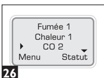
Dans cet exemple, 'Fumée' et 'Chaleur' sont combinées en tant que test simultané suivi par un test 'CO' (26).
