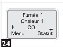
Dans cet exemple, 'Fumée' et 'Chaleur' sont sélectionnées comme un test simultané (24).
