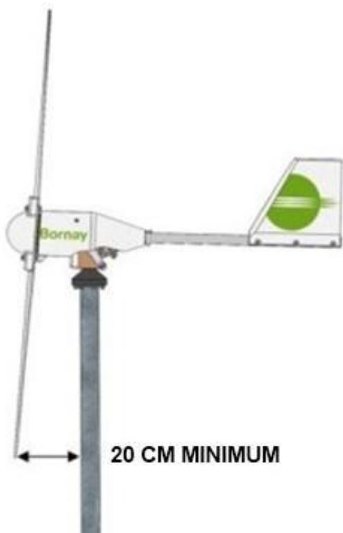
Une fois l'aérogénérateur installé sur la tour, vous devez tester si la machine est capable de girer librement et qu'il n'existe aucun obstacle autour des pâles.
