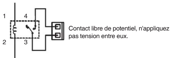
Fig. 15. Contact libre de potentiel "Dry_out".
