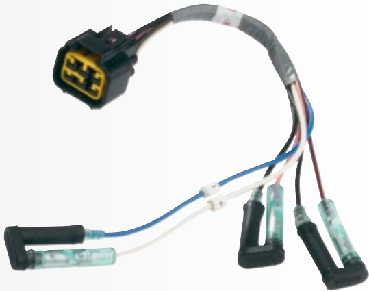
Faisceau de connexion pour 2 jauges à carburant et 1 GPS : 40 € Ce faisceau est utilisé pour connecter un GPS et une ou des jauges à carburant au speedomètre ou au speedo/carburant. Il est équipé d'un connecteur 6 broches (noir) et des connexions nécessaires pour les jauges et le GPS (NMEA 0183) 6Y8-8356N-01-00
