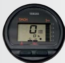
10 Compte-tours digital multifonctions : 366 € Indique les données : -régime moteur, -indicateur de trim, -niveau d'huile, -compteur d'heures, -témoin température d'eau.
