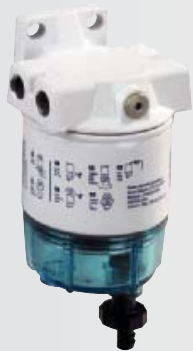
Pour moteurs HB jusqu'à 100CH : 119 € Filtration 10 microns. Débit maxi : 114 litres/heure. Dim. : H. 166 mm X 81 mm. Connecteurs 1/4 NPT YMM-2W114-00-00 (120R)
