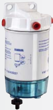
Pour moteurs HB jusqu'à 150CH : 129 € Filtration 10 microns. Débit maxi : 227 litres/heure. Dim. : H. 222 mm X 102 mm. Connecteurs 1/4 NPT YMM-2W227-01-00 (320R)
