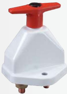
Coupe-batterie unipolaire : 43 € (finition marine, poignée rouge, rondelles et écrous laiton) AMP. (en continu) : 250A AMP. (pendant 5 s.) : 2500A YMF 110 SE1 004
