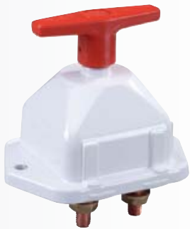
Coupe-batterie bipolaire : 102 € (finition marine, poignée rouge, rondelles et écrous laiton) AMP. (en continu) : 250A AMP. (pendant 5 s.) : 2500A YMF 110 SE1 005
