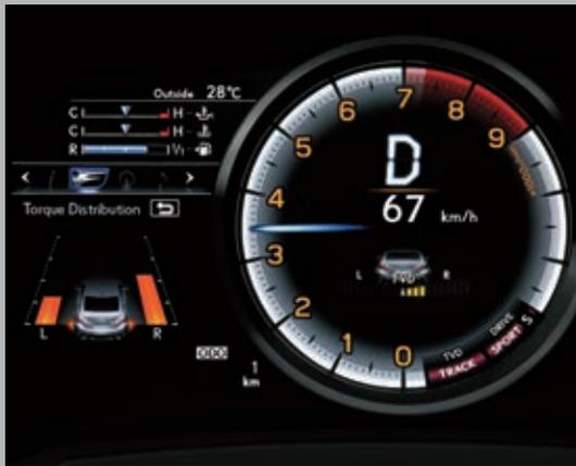
**AGILE, TRÈS AGILE OU TRÈS TRÈS AGILE** Vous serez impressionné de constater à quel point la conduite est plus réactive grâce au système de différentiel à répartition vectorielle du couple (TVD). Le TVD propose trois modes différents, Standard, Slalom et Track, qui optimisent la performance, les manœuvres de direction et la stabilité en fonction des conditions de conduite.
