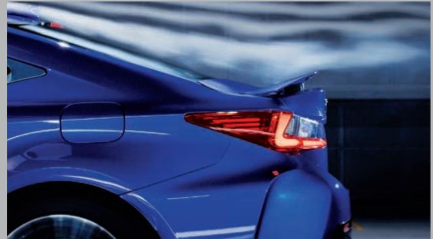
**AILERON ARRIÈRE ACTIF** Un aileron arrière se déploie à 80 km/h pour améliorer l'appui aérodynamique et la stabilité de conduite du véhicule. Cet aileron se rétracte à moins de 40 km/h. Offert avec le groupe Performance.
