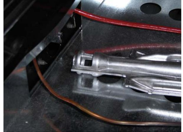
Régler le flux d'air principal en dévissant la vis P et en fixant l'intervalle X dans le cône de Venturi à 1/2" (5/16" pour le gaz naturel).
