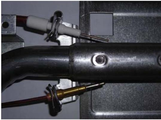
La pointe de la bougie d'allumage ou du thermocouple doit se superposer complètement au moins avec le premier orifice d'émission de gaz du brûleur.
