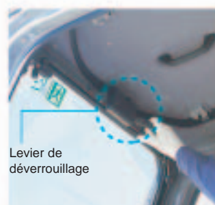
Loquet de vitre avant facilement déverrouillable
