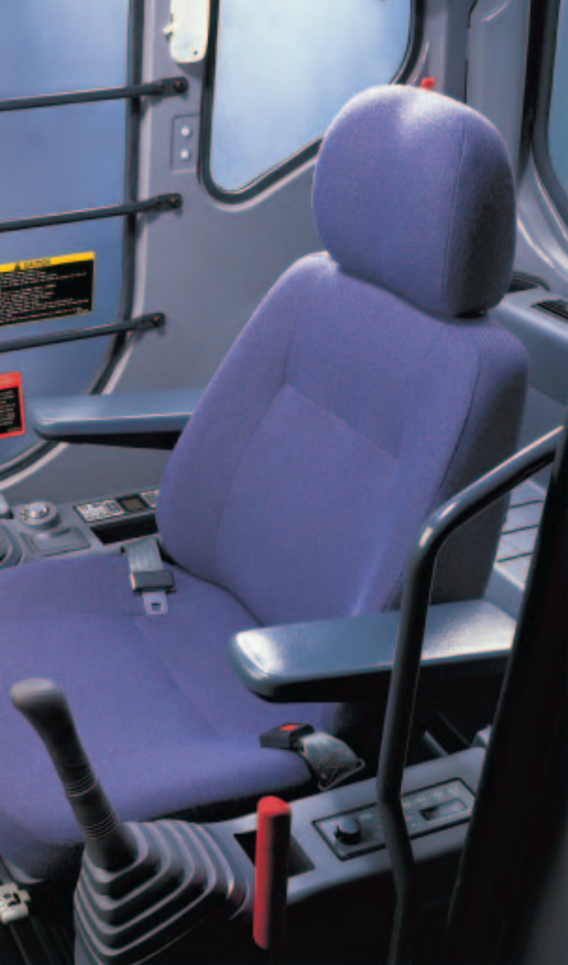
Lévier d'arrêt de commande pilote
